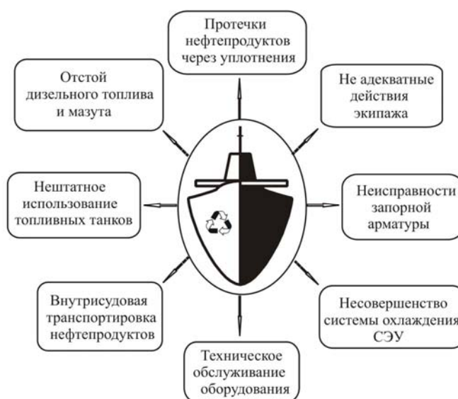
Рис. 1. Основные источники поступления горюче-смазочных материалов в льяльные воды
